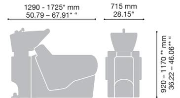
\* mit ausgefahrner Beinauflage // with extending leg rest
